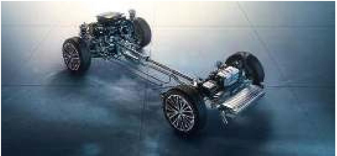
□ Das um 15 mm tiefergelegte Adaptive M Fahrwerk<sup>2,3</sup> passt sich automatisch dem Fahrbahnzustand und der Fahrweise an. Sie profitieren von ausgeprägter Fahrdynamik und einer hervorragenden Straßenlage bei gleichzeitig hohem Fahrkomfort und verbesserter Langstreckentauglichkeit. Die exklusive M Sportlenkung<sup>2</sup> vermittelt ein direkteres Lenkgefühl.
