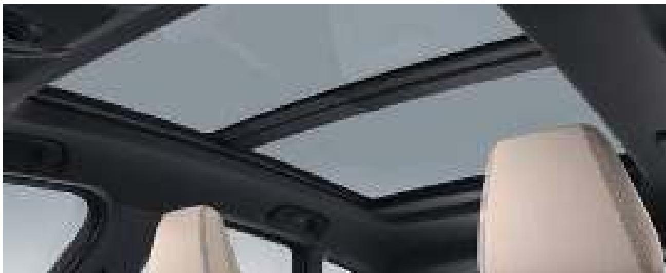
□ Panorama-Glasdach, elektrisch, mit Schiebe- und Hebefunktion vorn, Sonnenschutzrollo, Windabweiser sowie Komfortöffnung und -schließung über Fahrzeugschlüssel.
